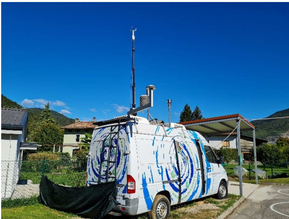
Slika 5.1: Mobilni kombi za meritve kakovosti zunanjega zraka in meteoroloških parametrov pri Vrtnu v Desklah.
