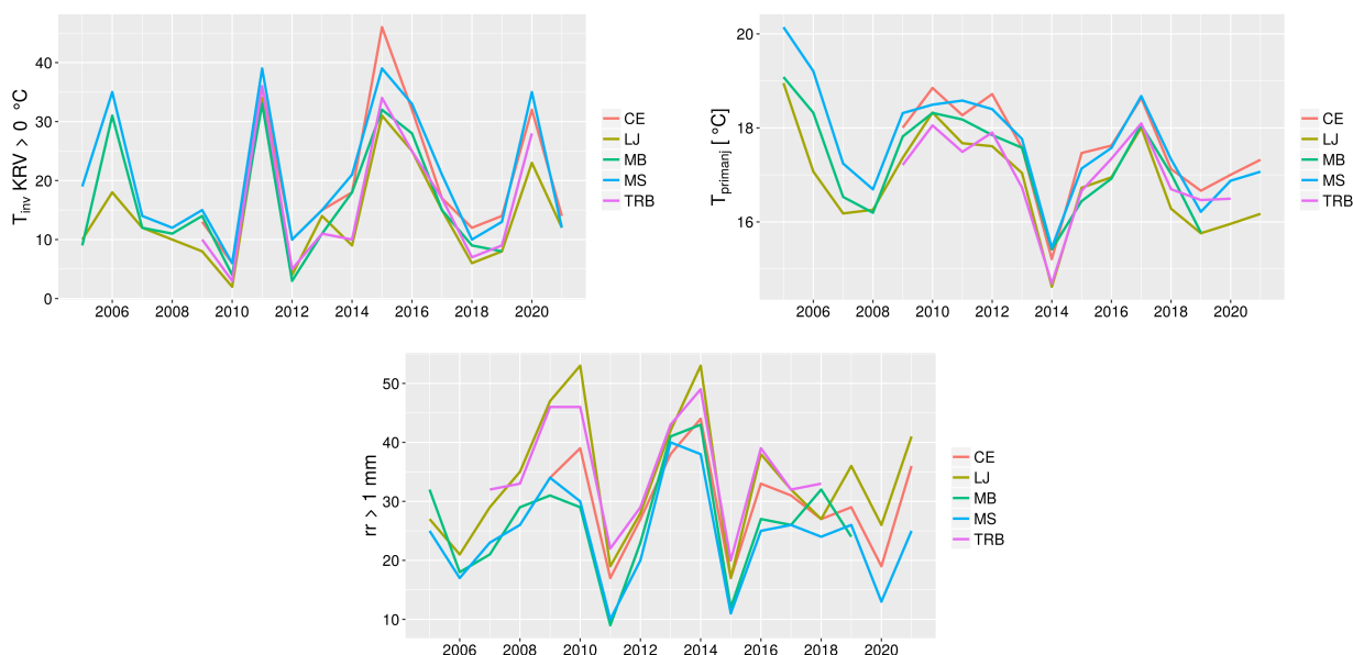
Slika 3.4: Število dni s temperaturno inverzijo med merilnim mestom in Krvavcem, povprečni temperaturni primanjkljaj in število padavinskih dni za mesece november, december, januar in februar po posameznih letih v obdobju med 2005 in 2021.
