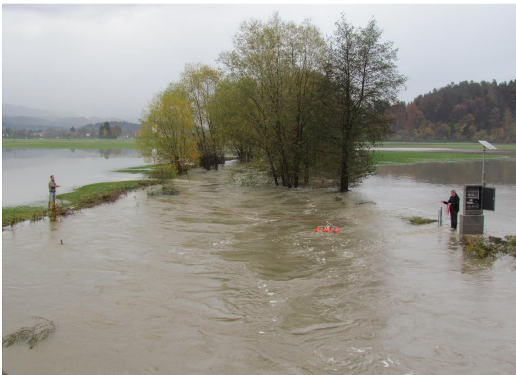
Slika 2: Meritev pretoka visoke vode Rače na Viru 8. novembra 2014 (foto: Marko Burger)
