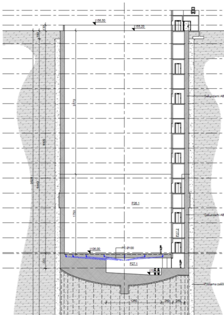
Slika 3-2: Shematsko prikazan odlagalni silos (povzet po IDZ, rev.C)
